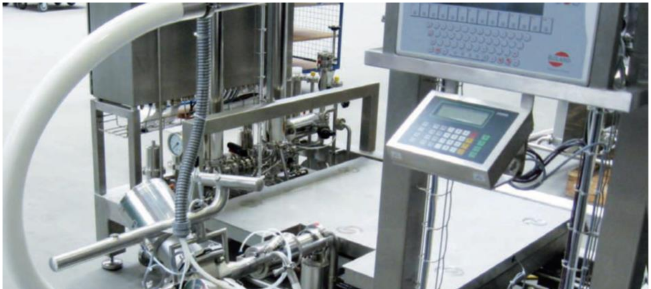
Containerstation mit integrierter Waage und Steuerung
