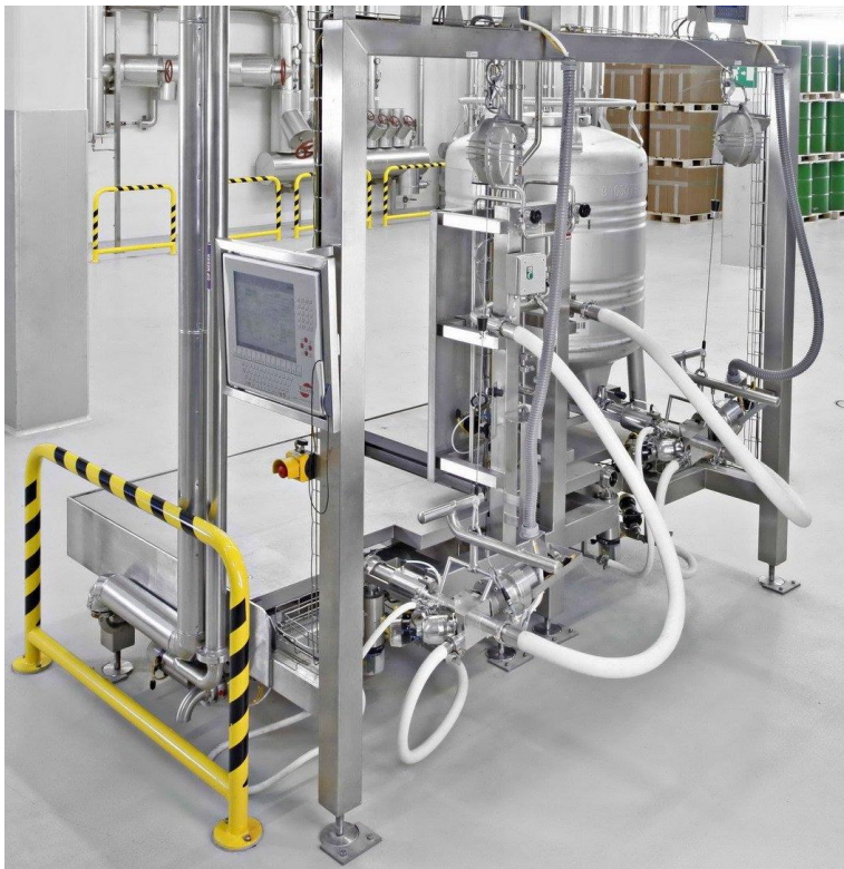
Containerstation mit Edelstahl-Behälter, Vorbereitung zur Befüllung
